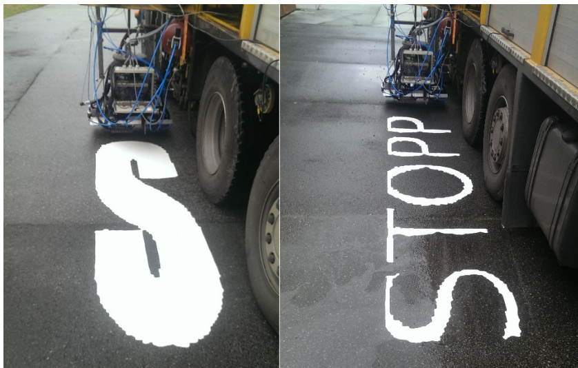
Bild 7, Test av tryckregleringens funktion med avseende på utfyllnad
