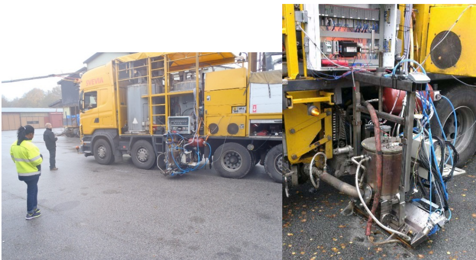
Bild 9, Test av tryckreglering med kugghjulspump
