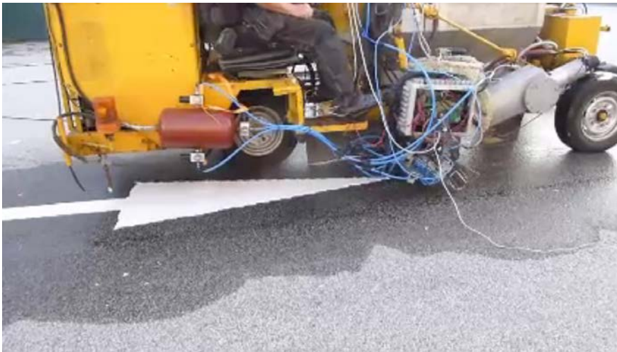
Bild 8, Test av tryckreglering med skrupvpump
