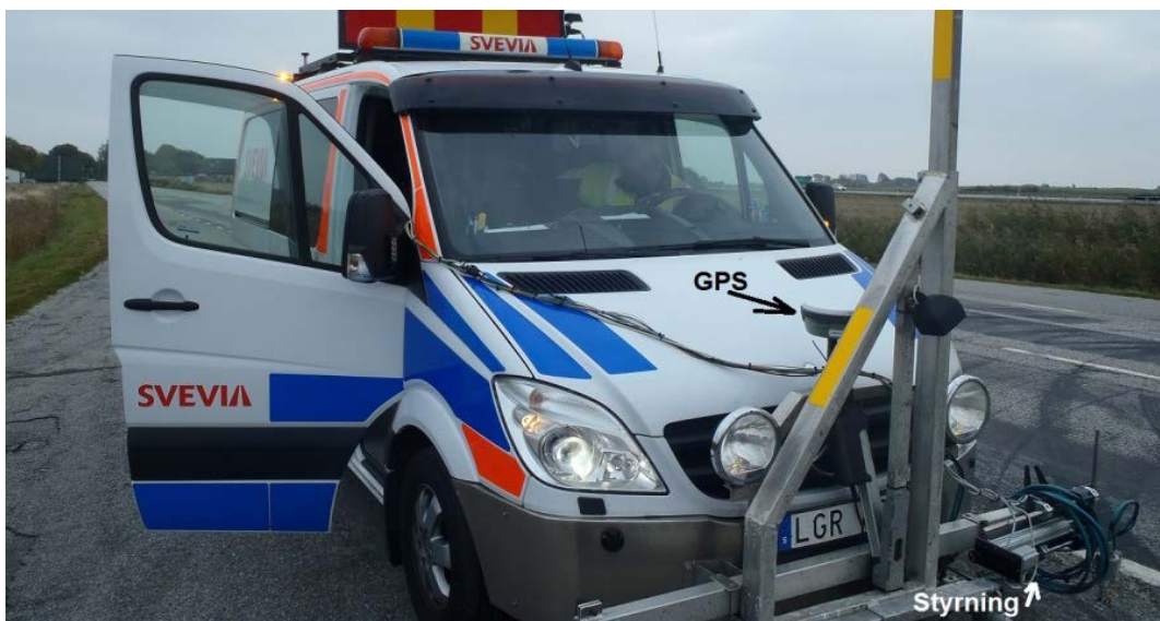
Bild 6, Utsättningsbil med provmonterad GPS utrustning.
