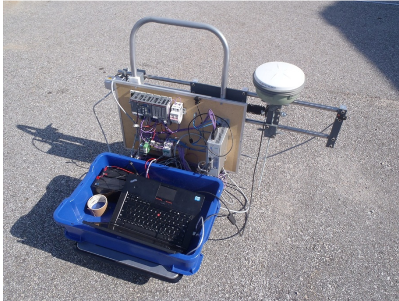
Bild 5, Testvagn för GPS-inmätning Fas1
